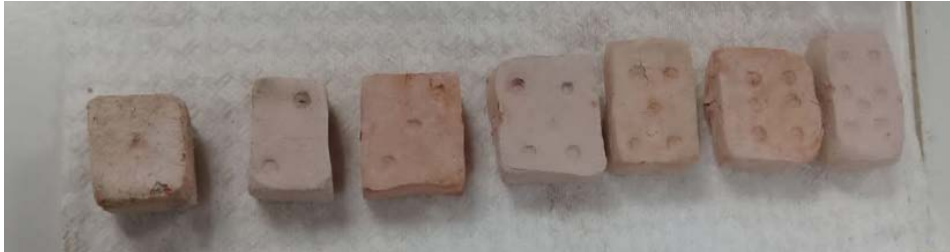
Figura 7. Muestras calcinadas a 900 °C usando lodo rojo residual ácido (7), lodo rojo alcalinizado con solución de cal al 5 % (13), lodo rojo ácido mezclado con bauxita (9, 11 y 12) y lodo rojo alcalinizado mezclado con bauxita (8 y 10)
