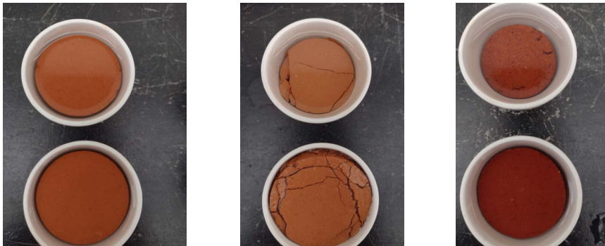
Figura 9. Imágenes del seguimiento a la descomposición de las muestras calcinadas sumergidas en agua por 24 horas
