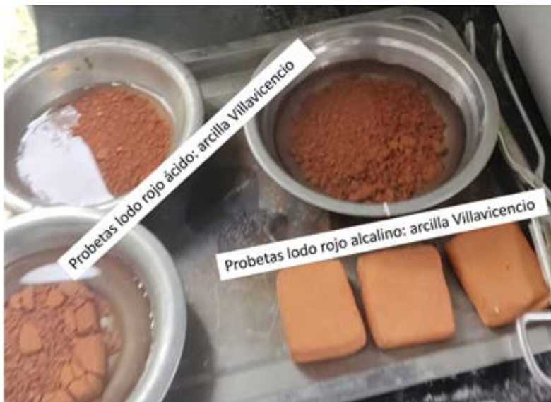
Figura 10. Imagen de seguimiento de descomposición en agua de probetas elaboradas en proporción 50:50 de lodo rojo ácido:arcilla V y probetas de lodo rojo alcalino: arcilla V
